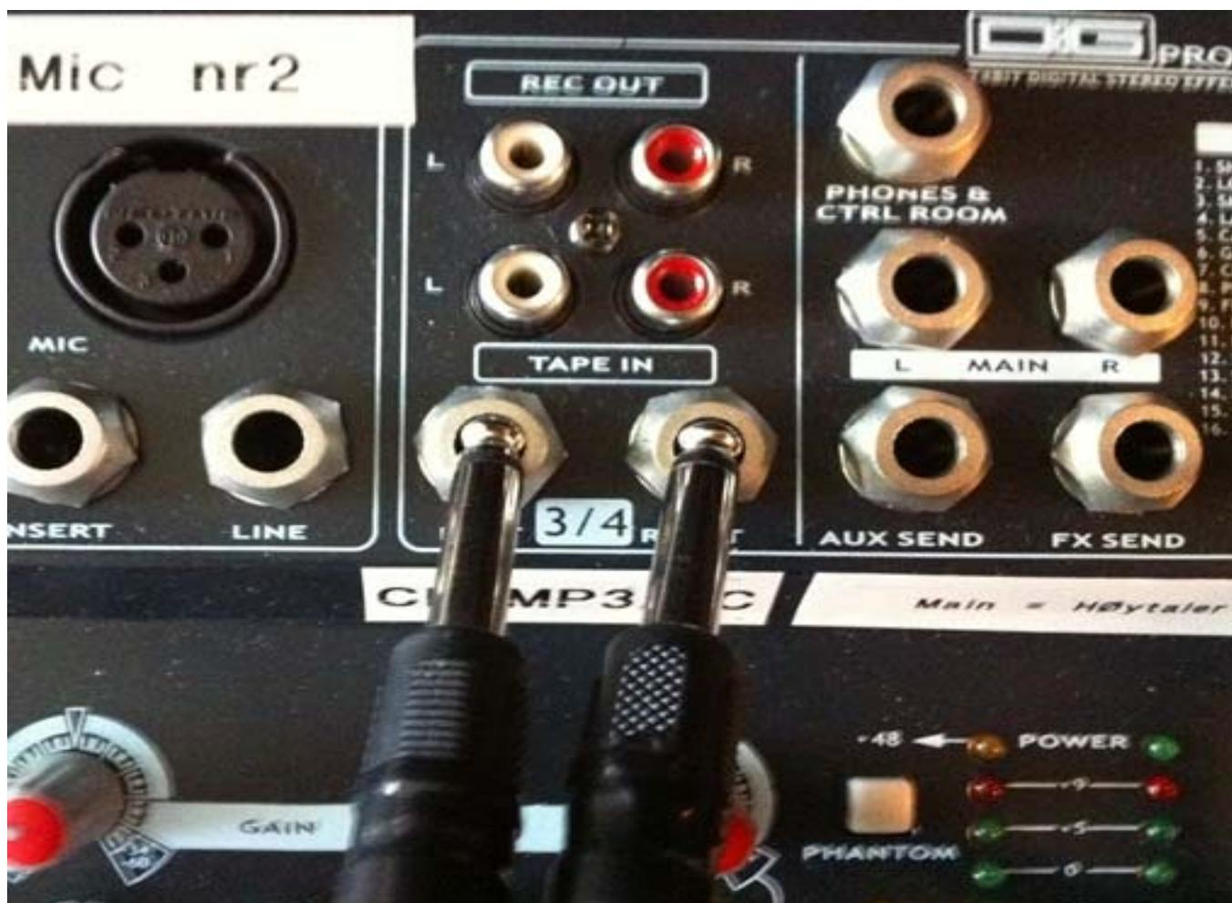
Koble den andre enden av kablene (med 2 stk «Jack» plugger) til kanal 3/4 på mikseren (\* Kanal 6/7 hvis du har «Karaoke mikseren»)
